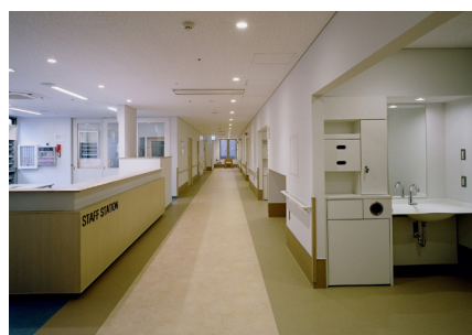
スタッフステーションと各4床室前に設けた洗面カウンター・PPE収納
